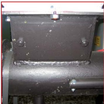
Puertecilla de descarga en la base de la tolva.
