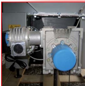
Embrague mecánico de protección del sinfin.
