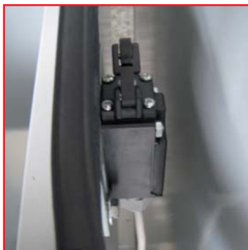
Sensor de seguridad de cierre de tolva.
